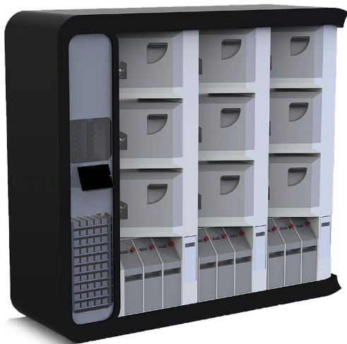
Fig. 3: Voilà à quoi pourrait ressembler la manufacture horlogère du futur: une production flexible capable de fabriquer des pièces uniques sur une série de micromachines modulables et interconnectées. Image: HE-Arc.
