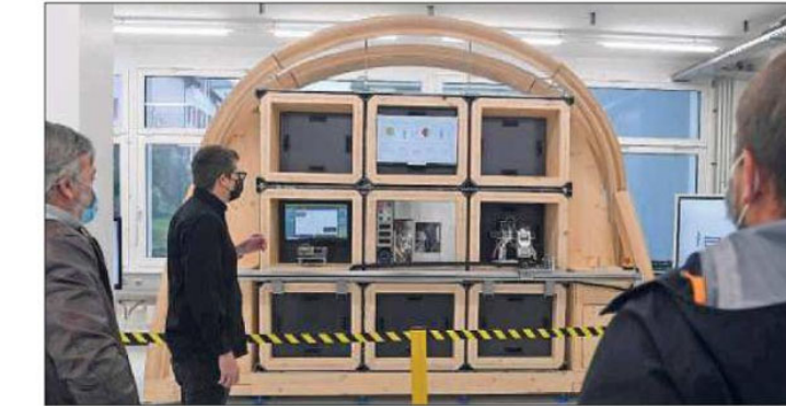
L'usine de demain? Des micromachines interconnectées entre elles, logées dans des cubes modulables selon les pièces à produire. Pièces menées d'une phase de production à une autre grâce à des robots. Ici, le prototype élaboré à Saint-Imier. PHOTO STÉPHANE GERBER
